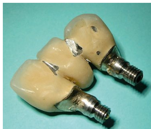
Figure 18. Fracture des éléments de fixation d'un bridge implantoporté ayant pour origine des malrelations mandibulomaxillaires.
