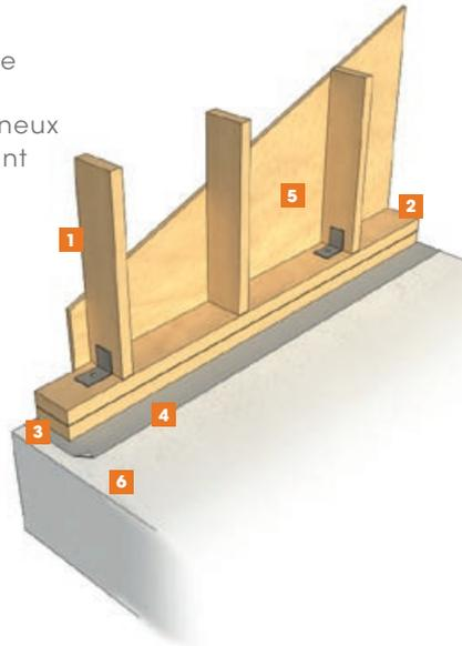
1.2 Mur ossature bois sur dalle béton
